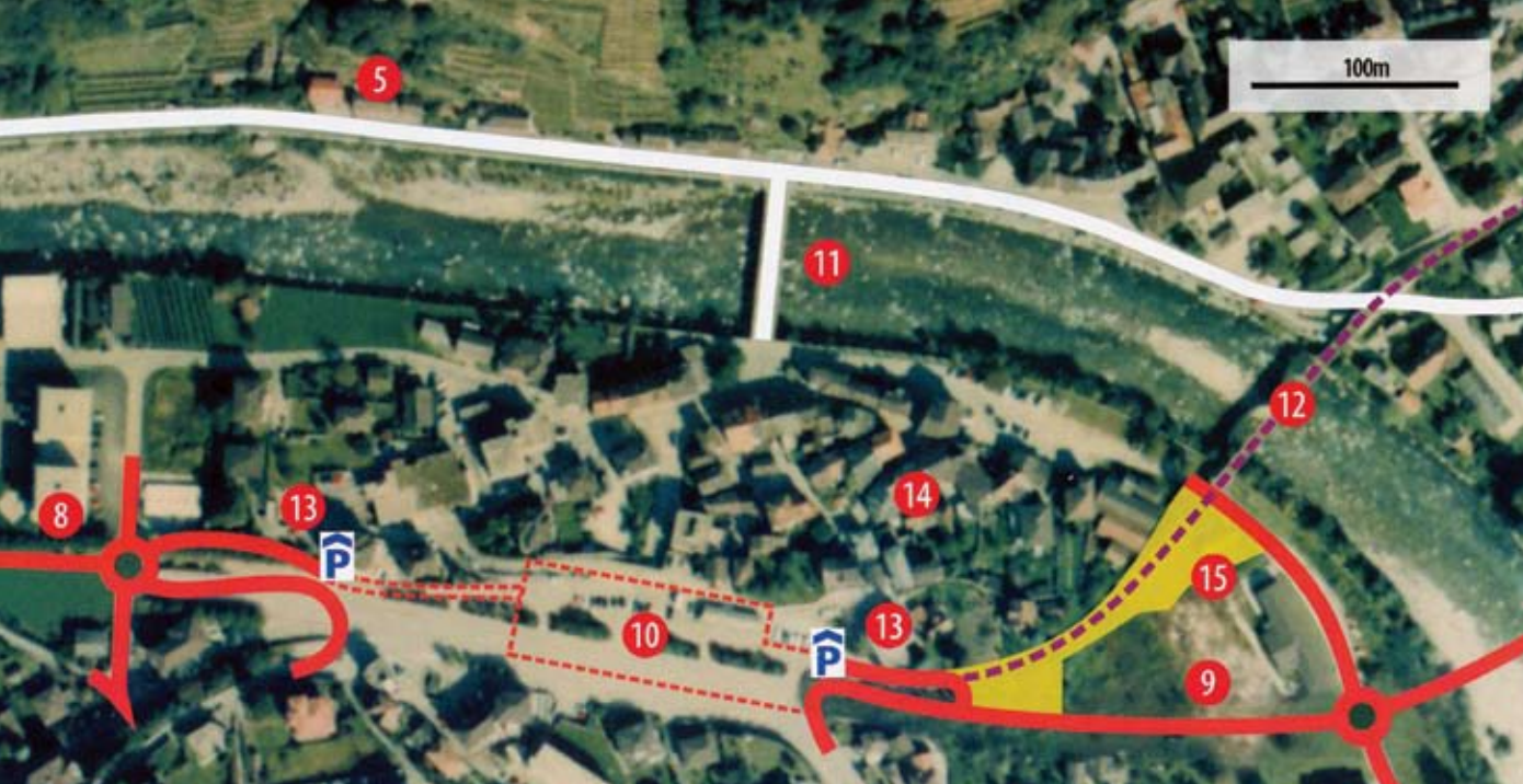
Neues Dorfzentrum: 5 existierende Kantonsstrasse, 8 und 9 Ost- und Westanschluss, 10 neuer Hauptplatz mit unterirdischem Parkhaus, 11 bestehende Bürcke über die Moesa, 12 neuer Fussweg, 13 Zufahrt zum unterirdischen Parkhaus, 14 Fussängerzone, 15 Parkzone (Bild: Toscano)
